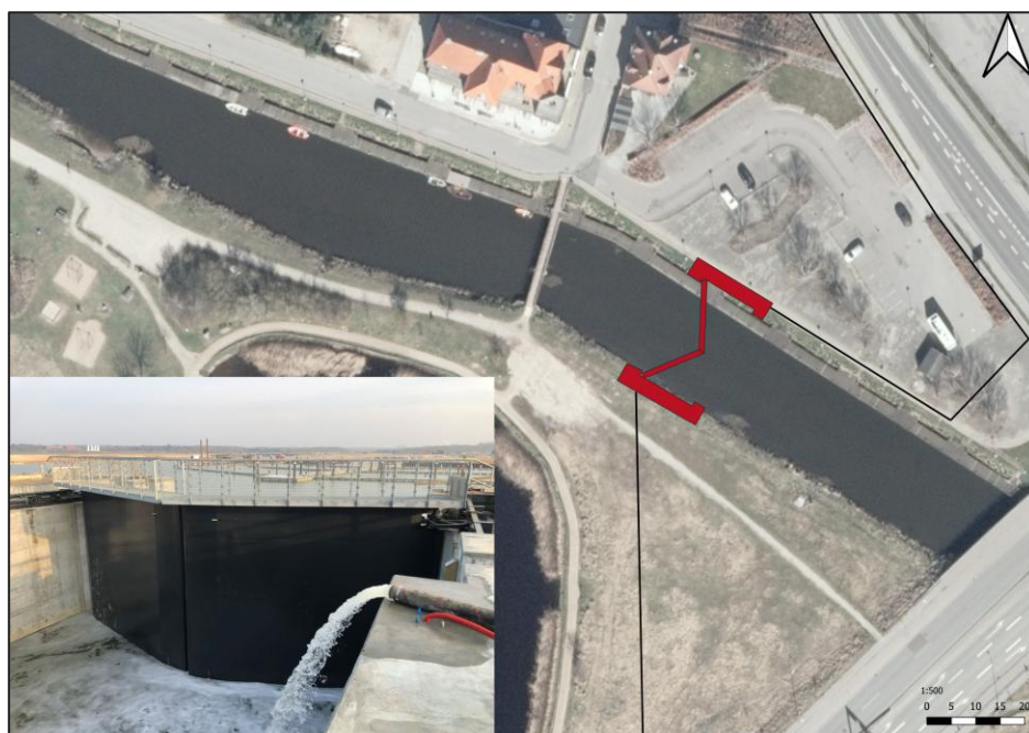
Figur 4.8: Billede af sidehængslet port i Esbjerg, totalrådgiver NIRAS, samt mulig placering og udbredelse af anlægget i Grenåen, (WINTeC - Big steel solutions, 2021). Den præcise placering af port fastlægges endeligt og er på figuren kun indikativ.
