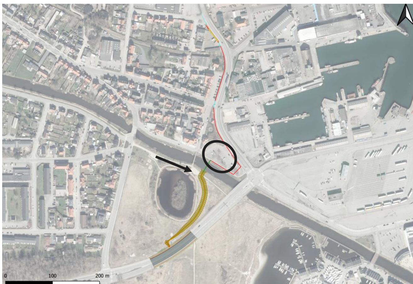
Figur 5.1: Det nuværende P-plads areal forventes benyttet til arbejdsplads under udførelsen. Sort pil angiver forventet adgangsvej til etablering af dige samt ved etablering af højvudslukket fra syd.
