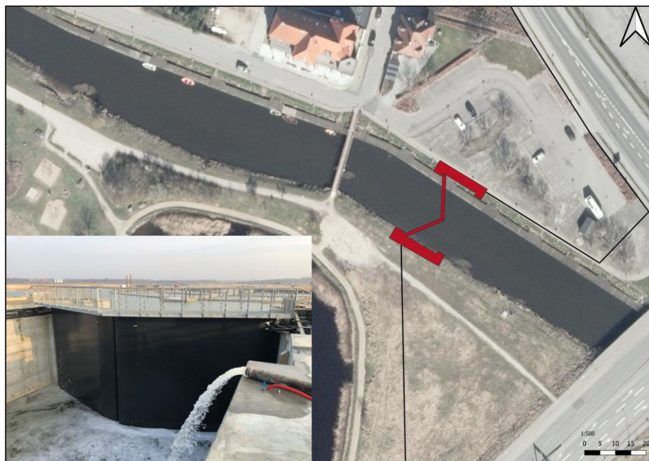
Figur 3.3: Billede af sidehængslet port i Esbjerg, totalrådgiver NIRAS, samt mulig placering og udbredelse af anlægget i Grenåen, (WINTeC - Big steel solutions, 2021). Den præcise placering af port fastlægges endeligt og er på figuren kun indikativ.
